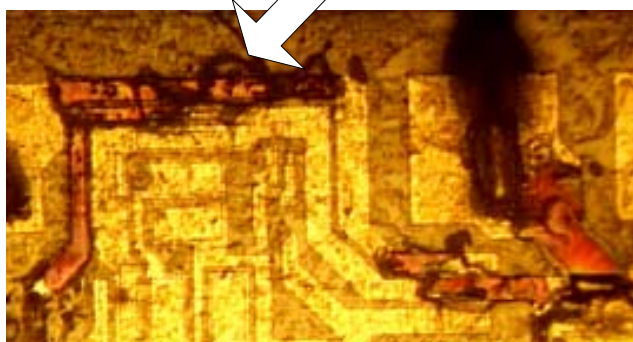
Рис. 12. Микрофотография кристалла ИМС 533ЛПЗ (вып. 974) с участками расплавления металлизации
