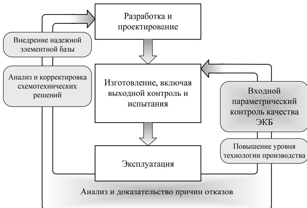
Рис. 3. Структура комплексного подхода к обеспечению качества аппаратуры ЖАТ
