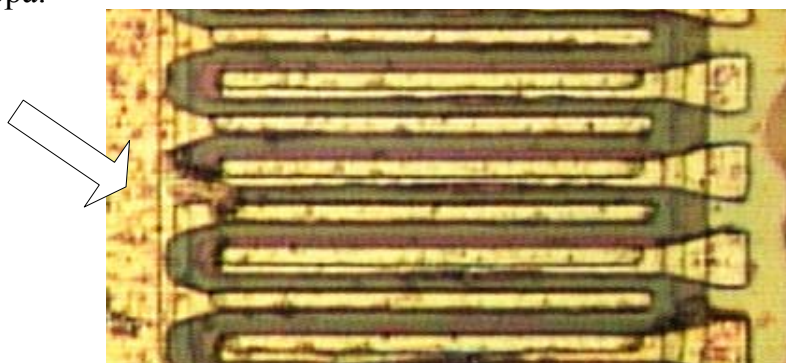
Рис. 17. Микрофотография фрагмента кристалла транзистора 2Т966А (вып. 8804) с дефектом металлизации
