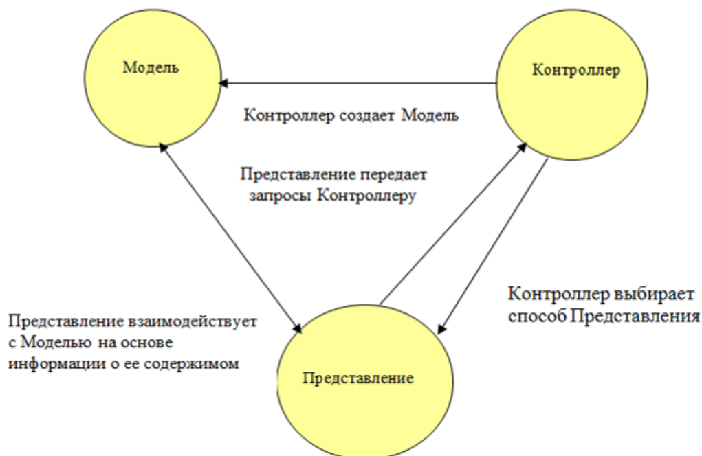
Рис.1. Шаблон проектирования Модель-Представления-Контроллер
