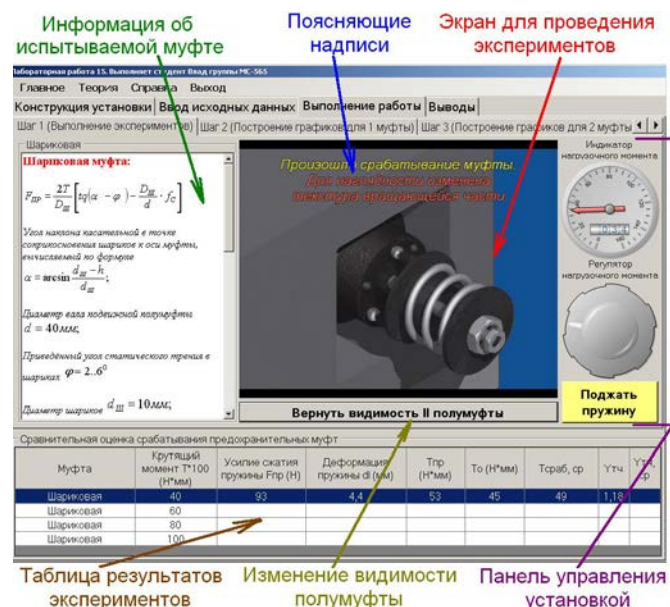
Рис 1. Исследование характеристик предохранительных муфт.
