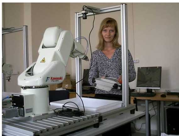
Рис. 1. Промышленный робот Kawasaki FS03N с шестью вращательными электроприводами в режиме ручного управления в РУДН
