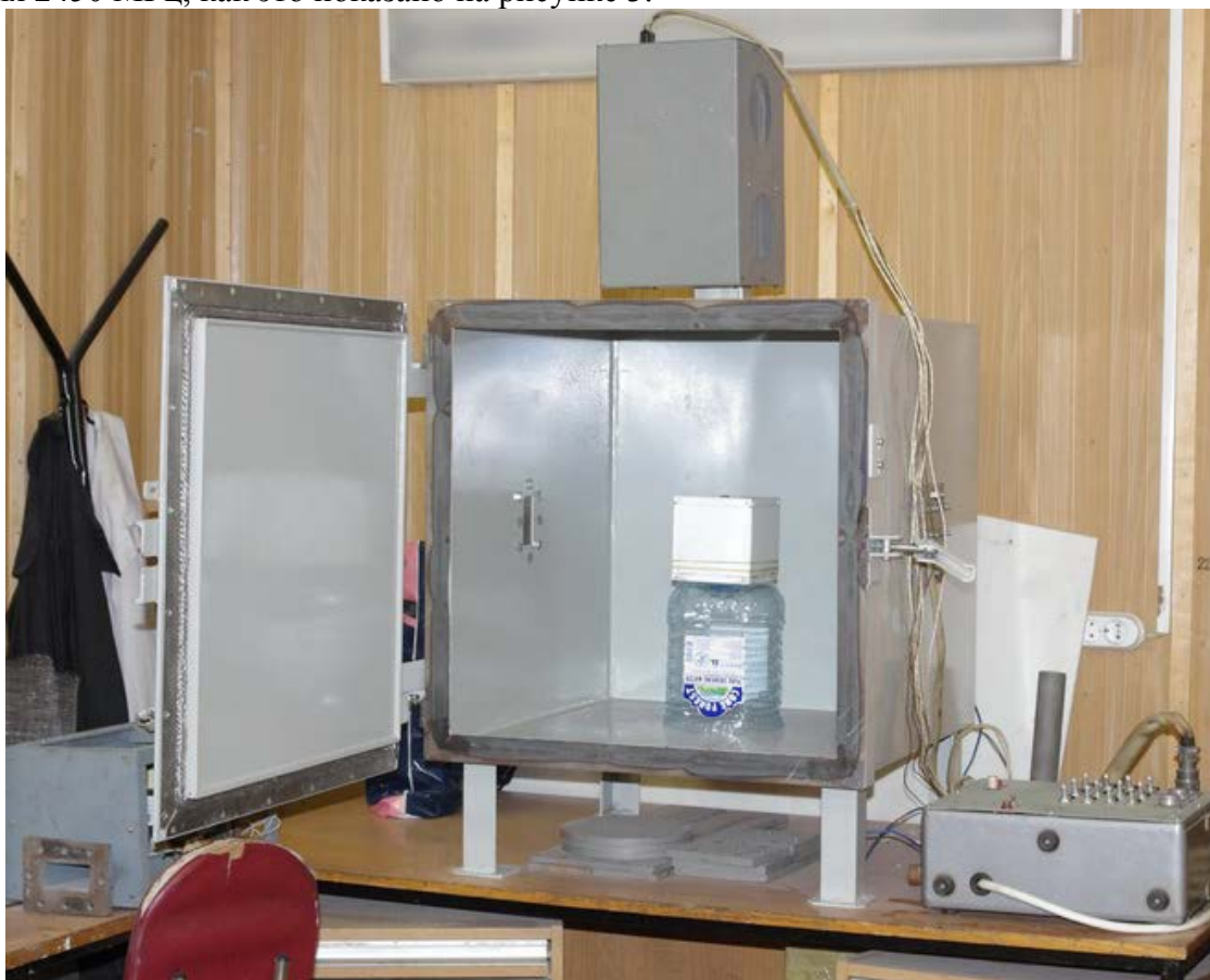
Рисунок 3. Фотография микроволновой установки лучевого типа с источником СВЧ энергии с помещенной в нее фторопластовой опалубкой.
