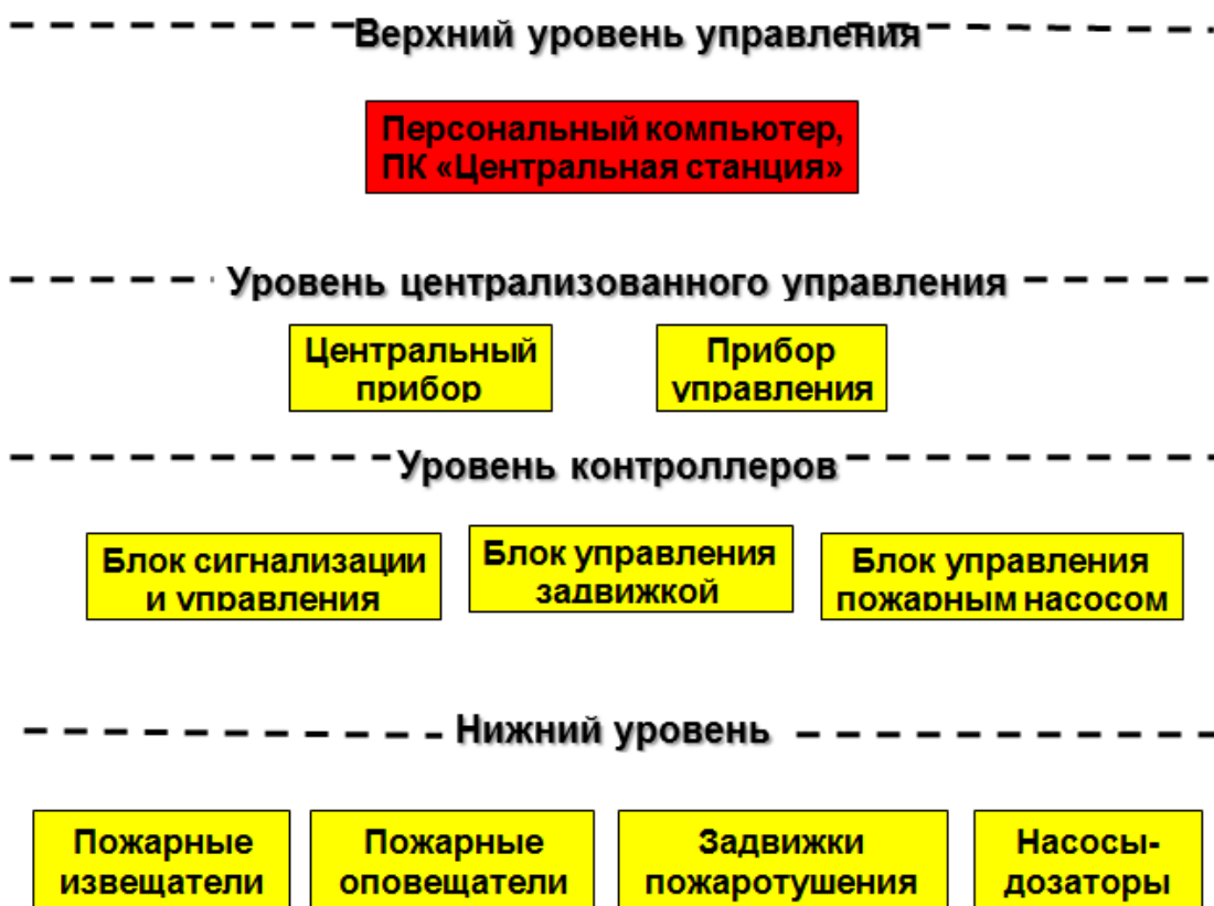
Рис. 1. Структура системы пожарной автоматики
