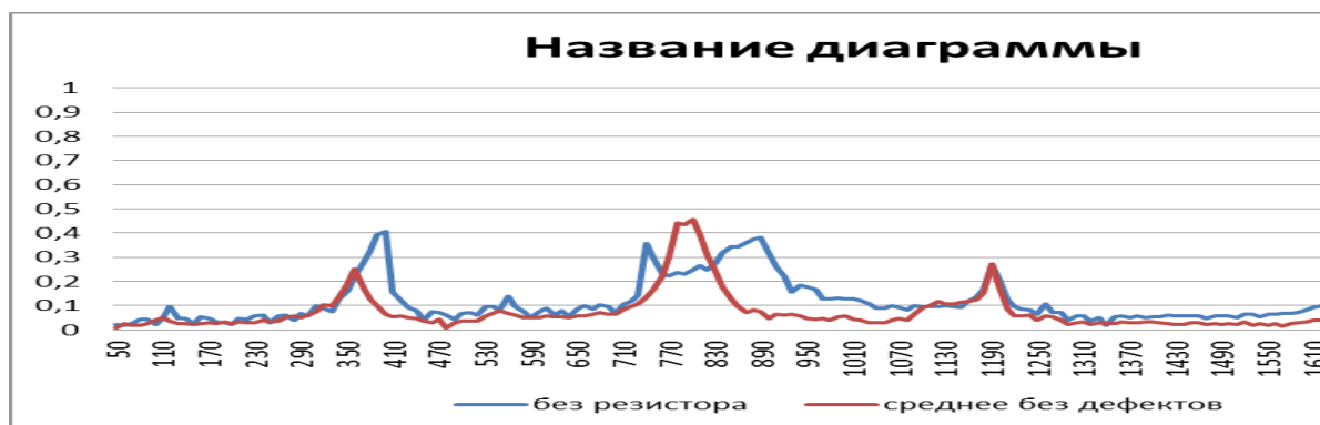
Рис.4. АЧХ печатной платы с дефектом: отсутствие резистора.
