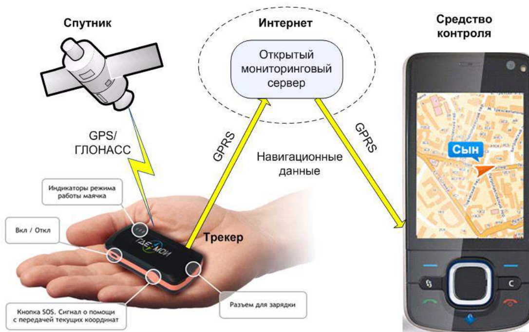
Рис.1. Система контроля посредством навигационных трекеров
