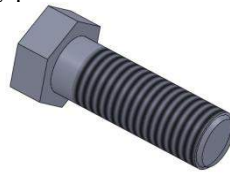
Рис. 5. Визуализации резьбы на поверхности болта
