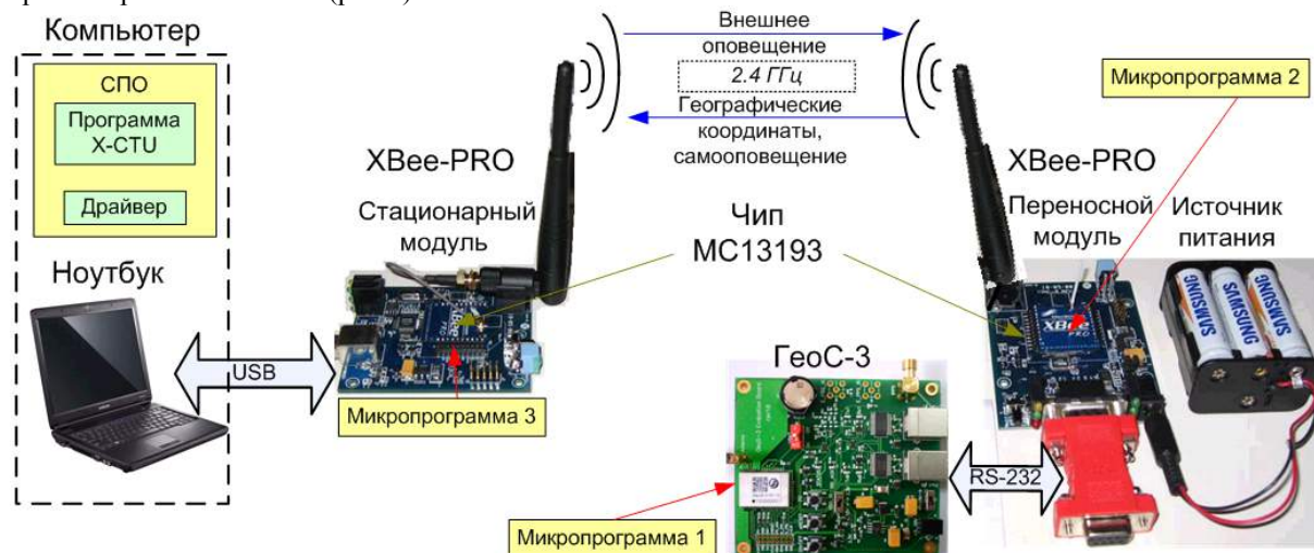
Рис.1. Система взаимодействия GeoC3 и XBee-PRO
