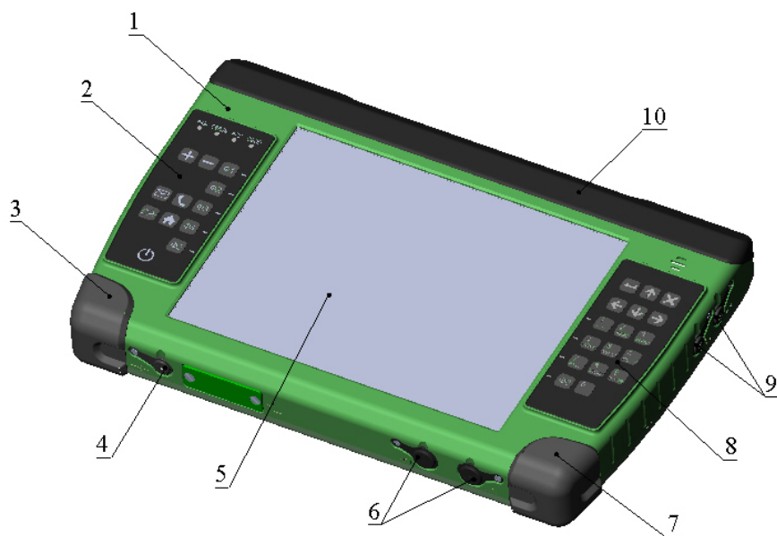
Рисунок 1 – Общий вид навигационного планшета 1- корпус; 2 и 8 – панели управления; 3 и 7 – амортизаторы; 4 – разъем питания; 6 – интерфейсные разъемы; 9 – высокочастотный разъем; 10 – защитная крышка.
