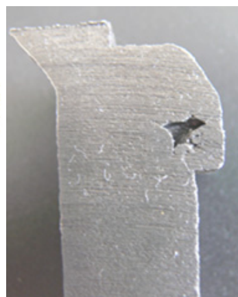
Рисунок 6.в. Фрагмент отливки «Крышка» с дефектом (увеличено)
