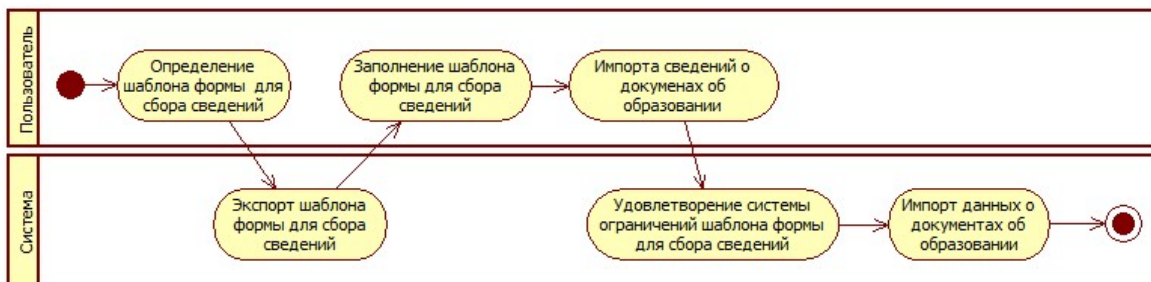
Рисунок 2 Алгоритм функционирования сервиса централизованного хранения сведений о документах об образовании
