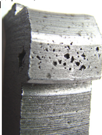
Рисунок 5.б. Фрагмент отливки «Крышка» с газовыми раковинами (увеличено)
