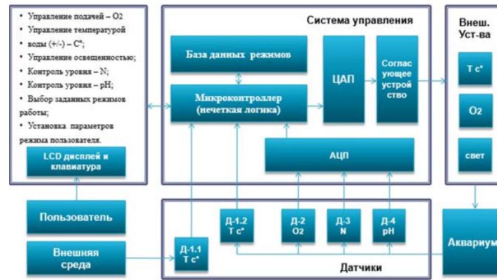
Рисунок 2 – Структурная схема автоматизированной системы управления микроклиматом в аквариуме
