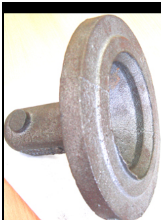
Рисунок 5.а. Отливка «Крышка» с невидимыми дефектами
