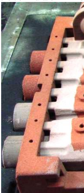
Рисунок 3. Стержень с вентиляционными каналами
