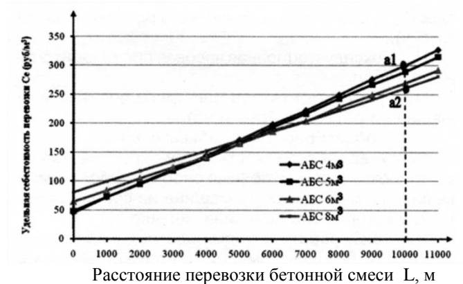
Рис. 2. Удельная себестоимость перевозки 1 м 3 бетонной смеси автобетоносмесителями различных типоразмеров в зависимости от расстояния перевозки
