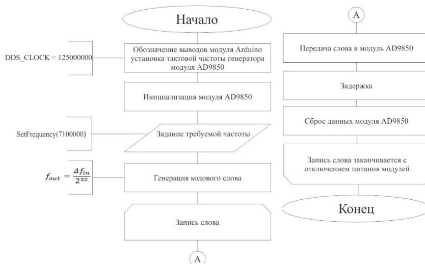
Рисунок 3. Блок-схема алгоритма управления модулем AD9850
