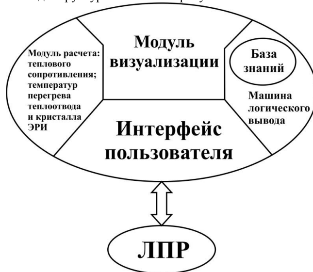
Рис.1 Структурная модель системы выбора теплоотвода радиокомпонента
