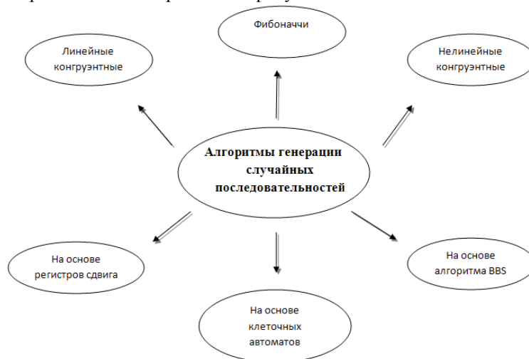
Рисунок 1 – Алгоритмы генерации случайных последовательностей
