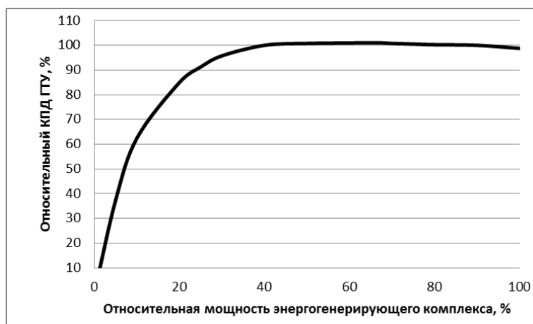
Рис. 6 Зависимость относительного КПД от относительной мощности ГТУ с регулируемым компрессором
