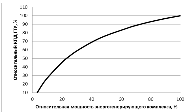
Рис. 3 Зависимость относительного КПД от относительной мощности ГТУ с нерегулируемым компрессором
