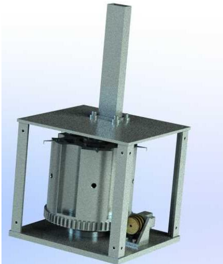
Рис. 4. 3D-модель сухого хранилища камерного типа
