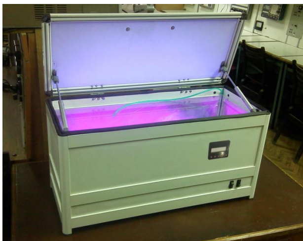
Рисунок 2 – Лабораторный стенд экспонирования фоторезиста
