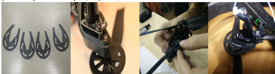
Рисунок 2 - Установка карбоновых ограничителей.
