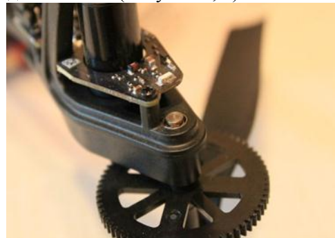
Рисунок 4 - Замена втулок скольжения на подшипники:
