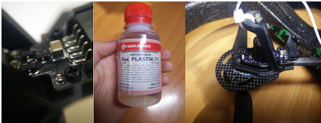
Рисунок 5 - Нанесение акрилового лака на открытые части платы управления моторами.
