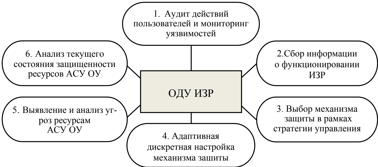
Рисунок 2.- Структура системы ИЗР с адаптивным дискретным управлением
