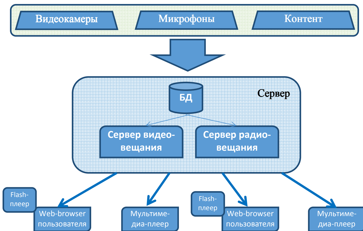
Рис. 2.1. Программно-аппаратный комплекс, обеспечивающий функционирование «Школьного Интернет-радио и Интернет-телевидения»
