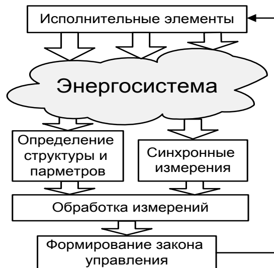
Рис. 1. Обобщенная структура замкнутой системы автоматического управления энергосистемой
