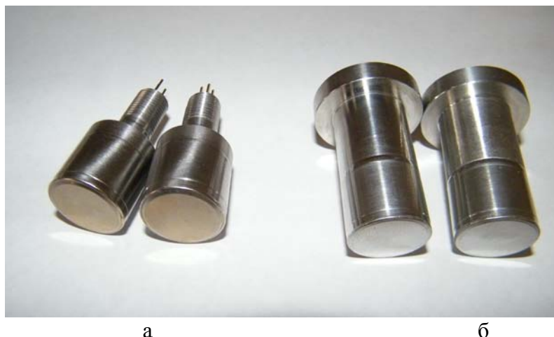
Рис.2. Внешний вид пьезоэлектрических преобразователей 223М(б) и 224М(а)
