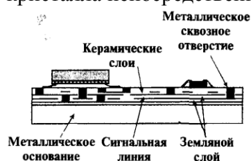
Рис. 2. Поперечное сечение односторонней LTCC-M платы.
