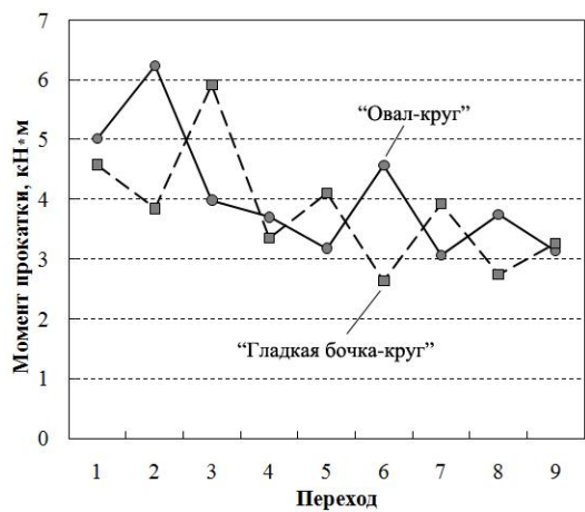
Рис. 5 Распределение момента прокатки по переходам
