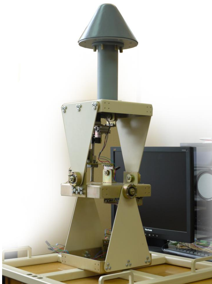
Рис.4 ИК подготовленный для стендовых испытаний
