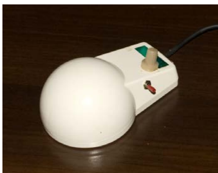
Рис.1. Внешний измерительный модуль (фотометрическая головка с блоком аналого-цифрового преобразования и интерфейсом).
