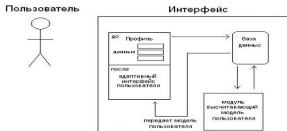
Рисунок 2. Блок-система адаптивного інтерфейса.
