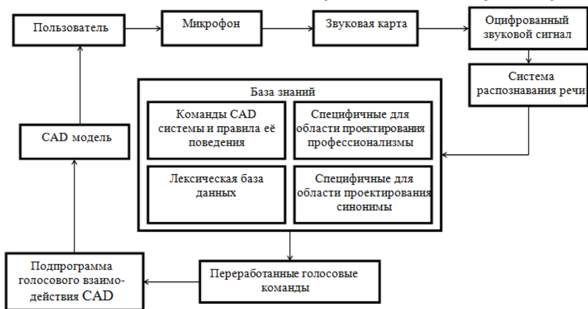
Рисунок 1 - Модель голосового управления CAD системой на тривиальном языке
