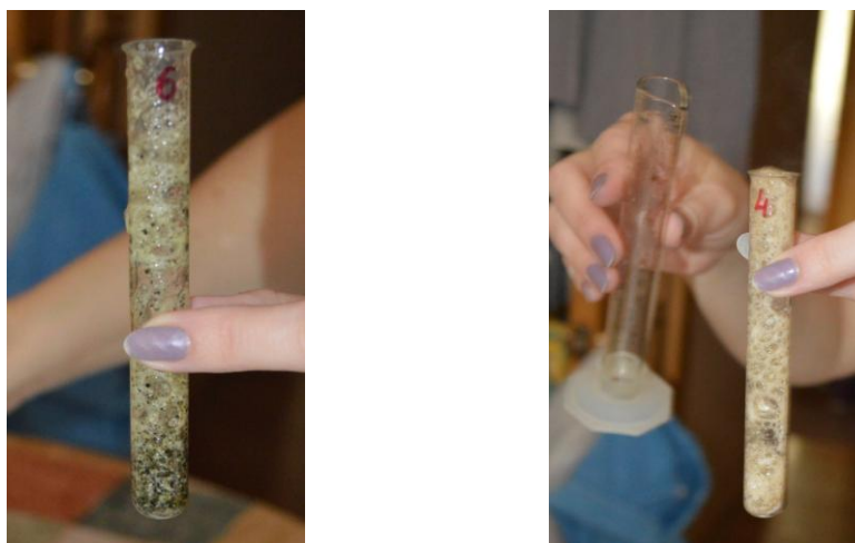
Рис. 3 Выделение газа при реакции образцов песка с кислотой
