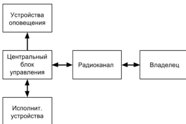
Рис.1. Базовая структурная схема бортовой радиоохранной системы МО
