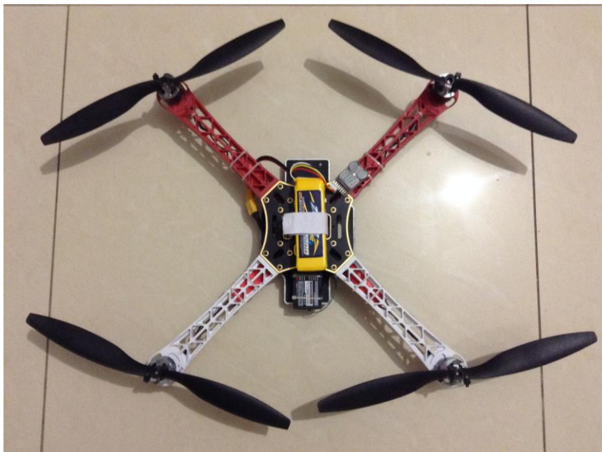
Рисунок 2 – Фотография изготовленного квадрокоптера
