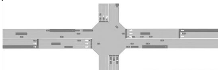
Рис 2. «Схема организации движения и работы светофоров при использовании приоритетной полосы прерывного действия с использованием программного пакета AIMSUN 6.1 (пункт 2-5)»
