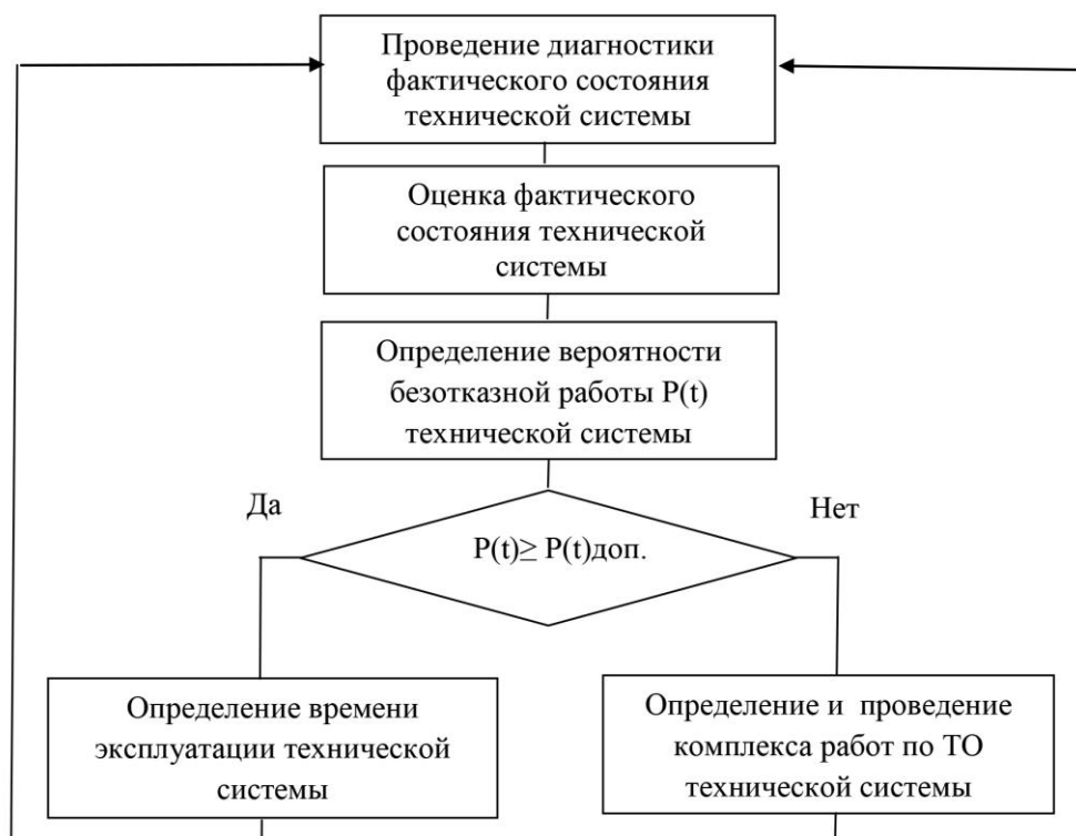
Рисунок 2 – Методика проведения технического обслуживания по фактическому состоянию
