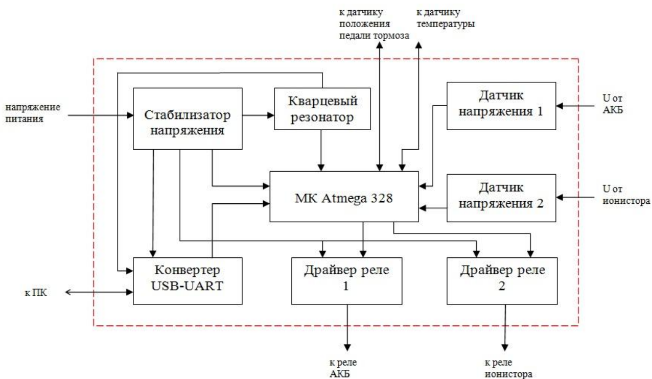
Рисунок 1 – Структурная схема ЭБУ
