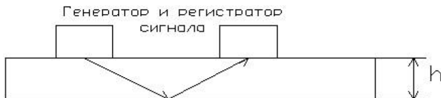
Рисунок 1 – Принцип действия ультразвукового толщиномера
