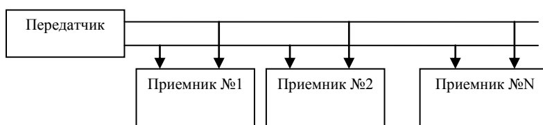
Рис. 1 Структура канала обмена в ARINC-429
