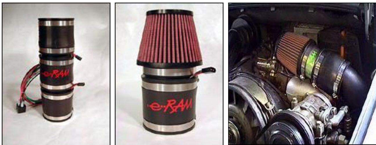
Рисунок 1- Внешний вид и установленный компрессор e-RAM на двигателе.
