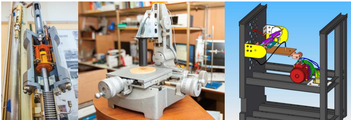
Рисунок 2 – Разработки лаборатории (слева направо): экспериментальный комплекс «ПОИСК» для проведения механических испытаний материалов в условиях реакторного облучения, лабораторный термоэлектрический толщиномер, 3D-модель станда ДТУ для исследования образования и роста усталостных трещин в металлах
