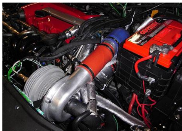
Рисунок 3 – Внешний вид и установленный компрессор VTES на двигателе
