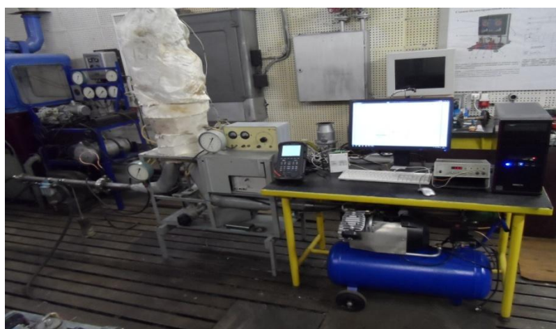
Рисунок 1. Стенд для определения теплогидравлических характеристик роторного теплообменника.
