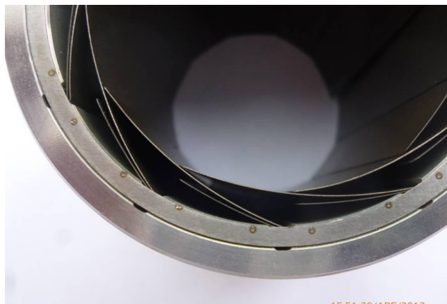
Рис.1 Радиальный лепестковый подшипник с дополнительными лепестками.
