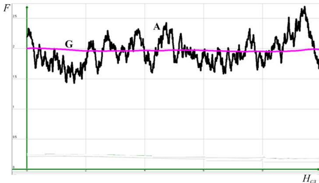
Рис. 3. Осциллограммы регистрации и поканальной обработки сигналов детектора: G – вычисленное среднее значение, F – вероятность не превышения случайной величины H_{ст} в регистрируемом сигнале A
