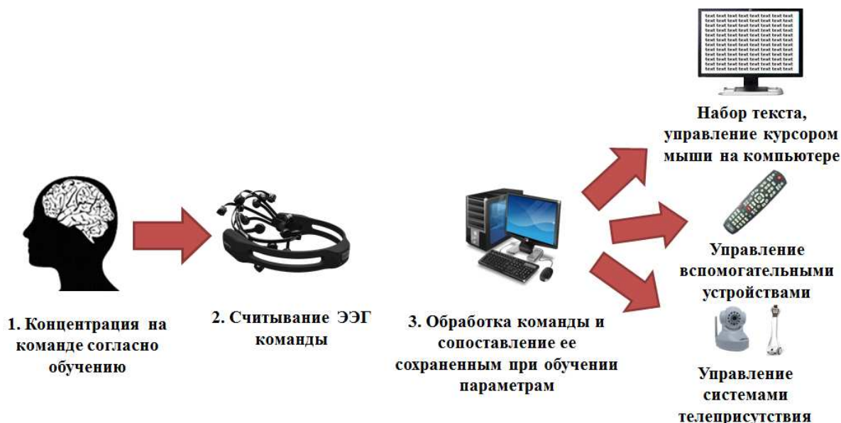
Рис. 1. Общий принцип работы системы для людей с ограниченными возможностями на основе нейрокомпьютерного интерфейса
