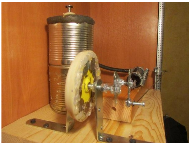
Рис.2. Первая (малозффективная) реализация компактного парового двигателя.
