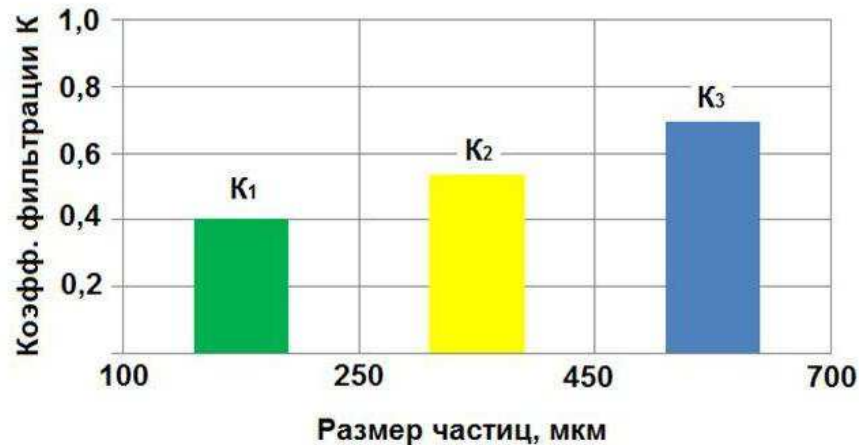
Рис. 1. Значения коэффициента фильтрации K для частиц различных размеров
