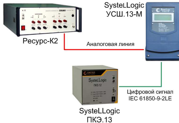
Рисунок 2 — Структурная схема стенда для проверки УСШ
