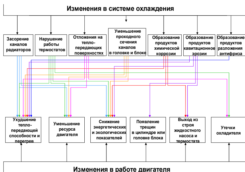
Рис. 1. Влияние изменений в системе охлаждения вследствие ее загрязнения на работу двигателя
