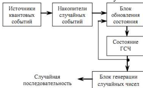
Рис. 2. – Структура ГСЧ, основанного на источнике квантовых событий
