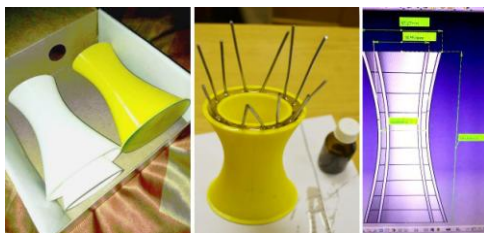
Рис. 1. Процесс изготовления секции модели башни на основе 3D-печати
