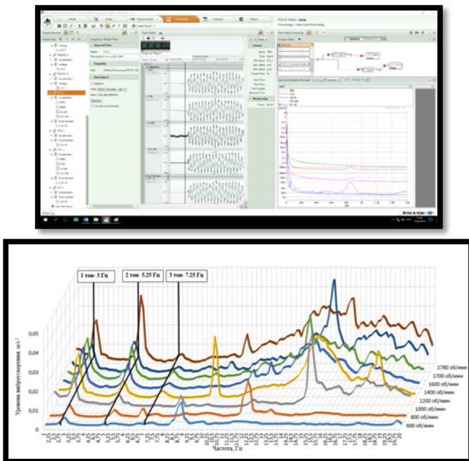
Рис. 6. Обработка сигналов в программе Pulse и графики с определением тона колебаний
